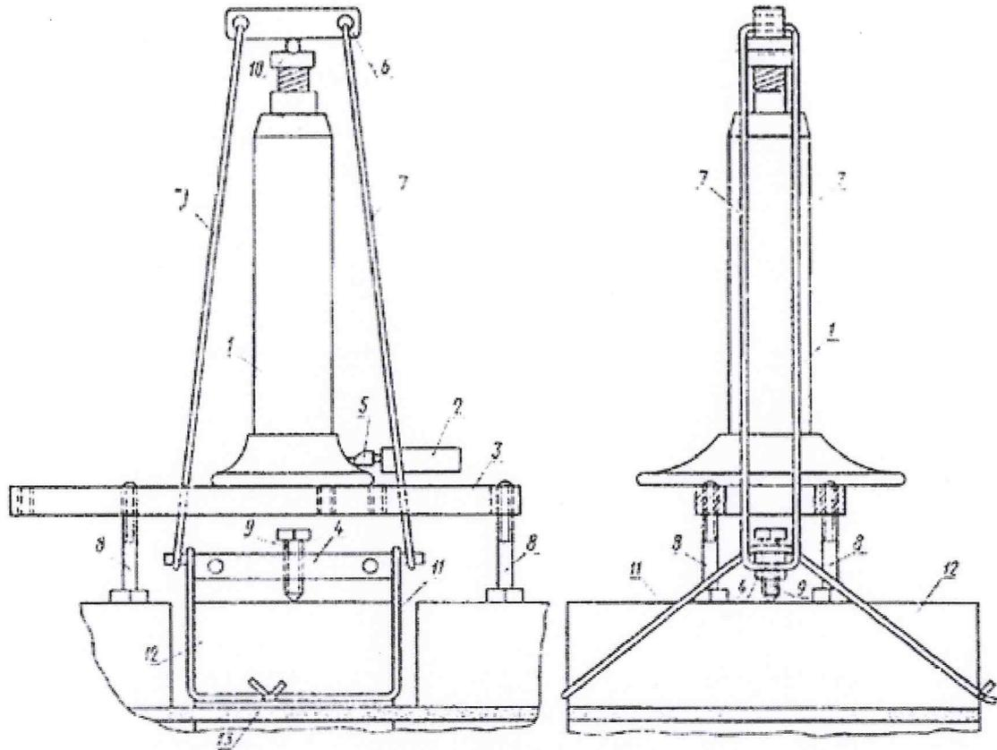
1 - гидравлический домкрат; 2 - манометр; 3 - рама; 4 - перекладина; 5 - переходник; 6 - траверса; 7 - тяги; 8 - стойки; 9 - регулировочный болт; 10 - шарнир; 11 - тросовый захват; 12 - испытуемый кирпич; 13 - узел троса.
