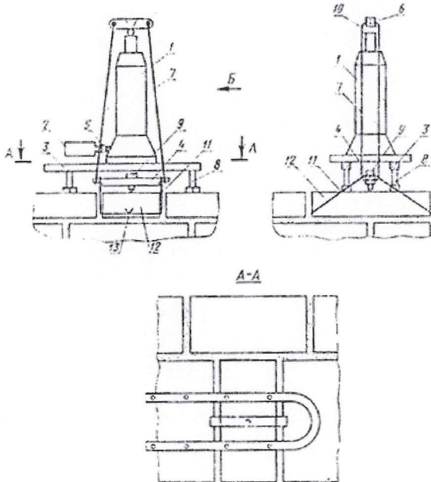
1 - гидравлический домкрат; 2 - манометр; 3 - рама; 4 - перекладина; 5 - переходник; 6 - траверса; 7 - тяги; 8 - стойки рамы; 9 - регулировочный болт; 10 - шарнир; 11 - тросовый захват; 12 - испытуемый кирпич (камень); 13 - узел троса.
