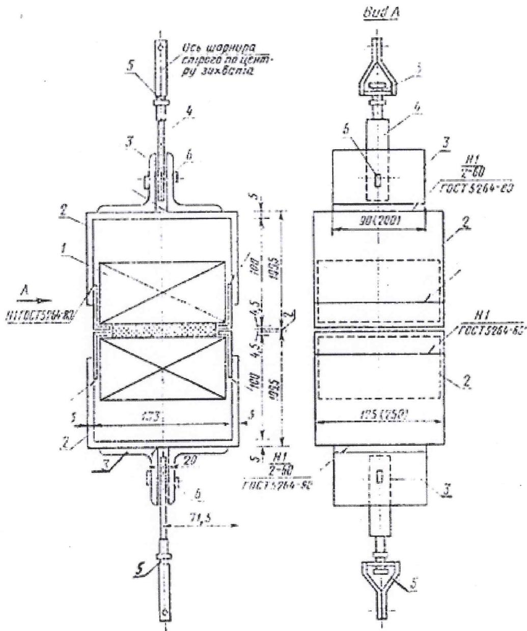
1 - образец; 2 - металлический захват; 3 - уголки 60×60×6 мм; 4 - металлическая пластина 20×90×6 мм; 5 - шарнир; 6 - шпилька.
