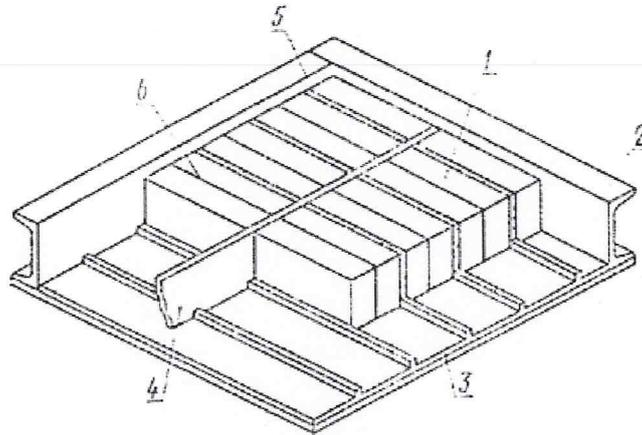
1 - образец; 2 - металлическая форма; 3 - коврик из резины; 4 - прокладка из плотной резины; 5 - швы, заполненные раствором; 6 - швы не заполненные раствором.
